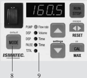
Anzeige der Betriebsart LEDs for operating modes Affichage du mode d'opération
